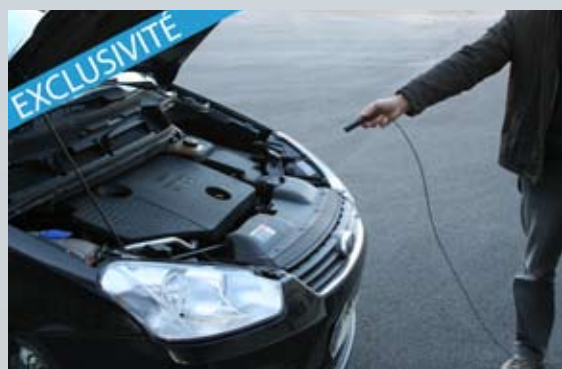
Capteur Infra-rouge : contrôle instantané et sans contact de la température moteur
